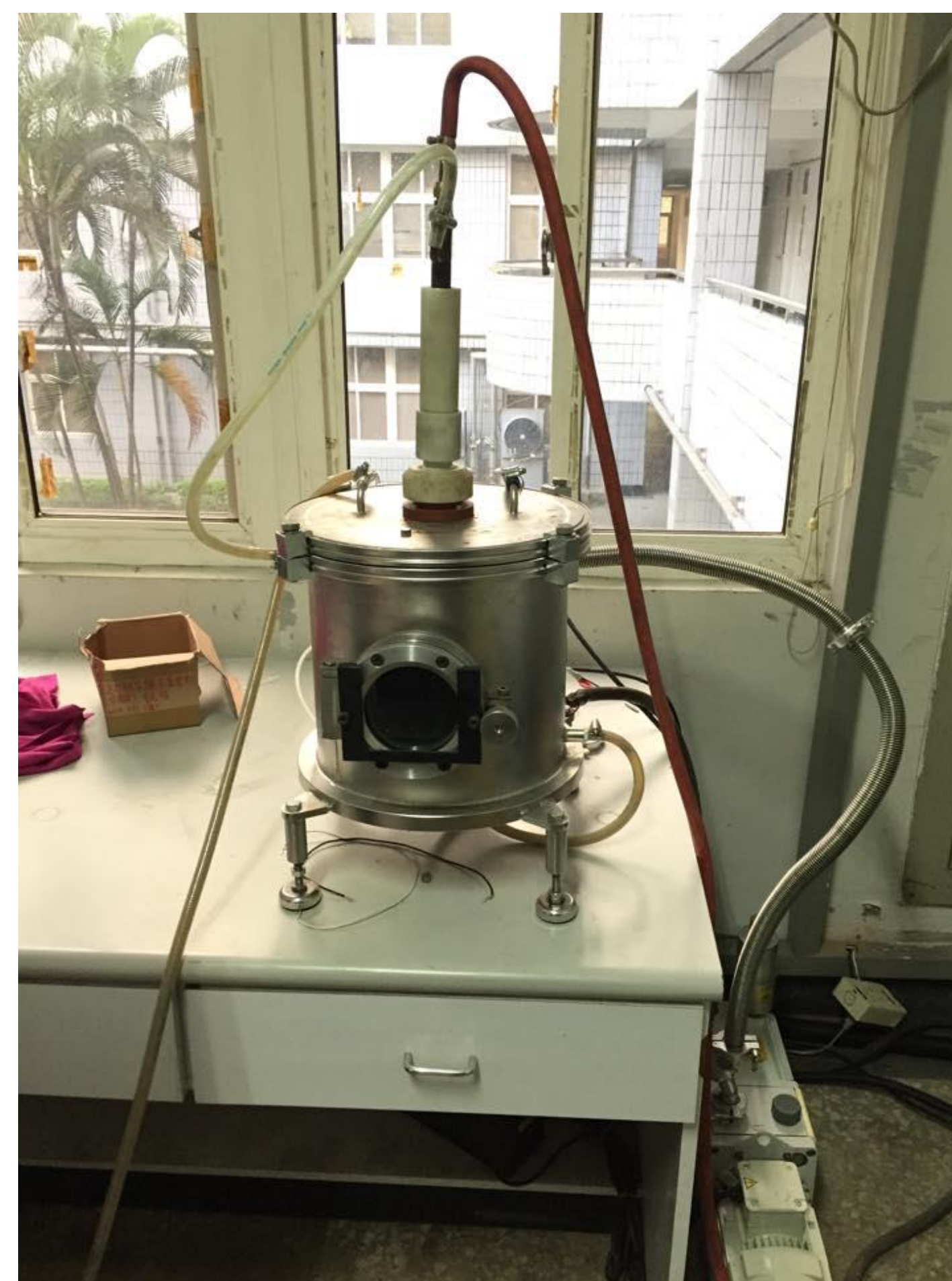
真空電弧熔煉爐
